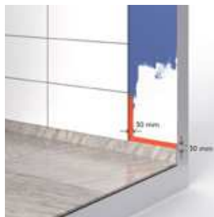
BILD L – Anslutning till målat tätskiktssystem
