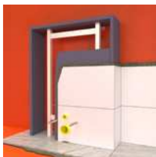
BILD O – Tätskikt bakom inbyggd WC
