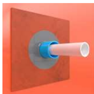
BILD H – Försegling mot skyddsror Försegling mot rör-i-rör sker mot skyddsroret.
