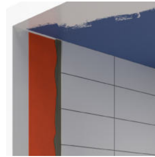
BILD N – Tak målat efter platsättning Är taket inte målat innan platsättning bör tätskiktet avslutas så nära taket som möjligt men kan avslutas max 50 mm från taket.
