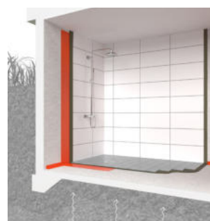
BILD A – Källare med tillskjutande markfukt Krav på tätskikt för golv och yttervägg är undantaget där risk för tillskjutande fukt föreligger.
