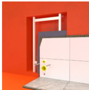
BILD P – Tätskikt bakom inbyggd WC i vägg Tätskikt ska finnas under och bakom den inbyggda spolcisternen. Eventuellt läckage vid armaturen ska rinna ut till våtrummet.
