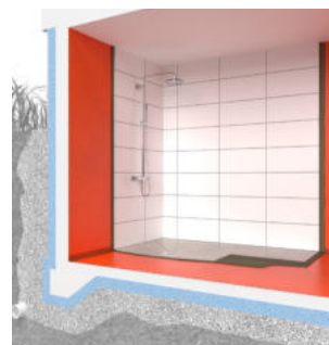
BILD B – Källare utan tillskjutande markfukt Vid en isolerad och dränerad källare ska tätskikt utföras enligt branschreglerna på alla ytor i våtrummet.
